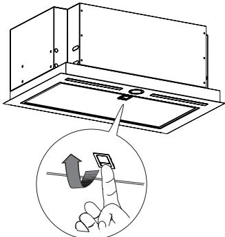
**Sostituzione delle lampade**
