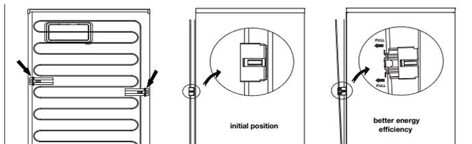
/ réfrigérateur et le mur pour permettre une bonne circulation de l'air. (Le schéma présenté est fourni à titre indicatif et peut ne pas correspondre exactement avec votre produit.)
